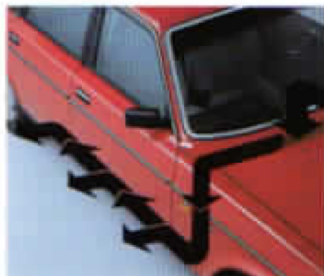
Så här ventileras trösklarna
