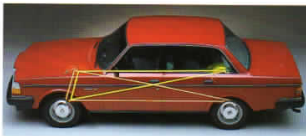
Det dubbla, inbäddade bromssystemet
