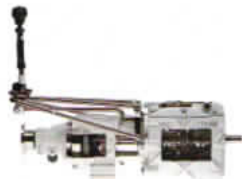
Den 4-växlade lådan med elektrisk överväxel
