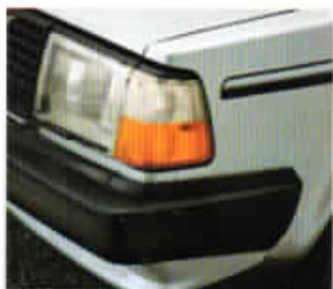
3. Nya lättare stöttångare, som går mer "runt hörnen", reducerar total längden på bilen.
