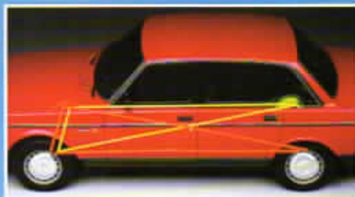
Två-krets, triangelvälad skivbromssystem. 80% av bromseffekten kvarstår om en krets skadats.
