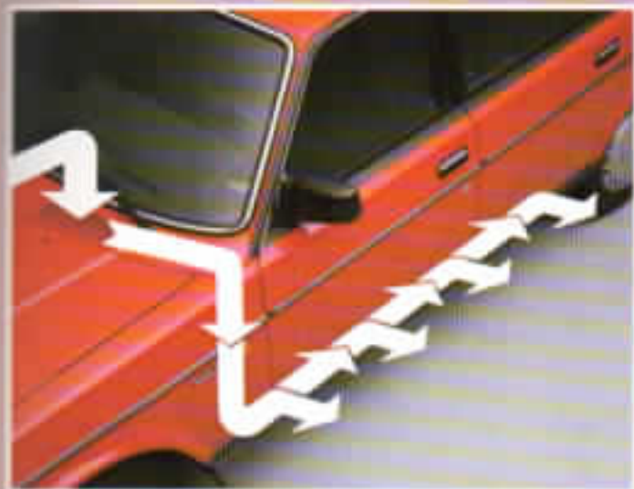
Ventilerade trösklar förhindrar rostangrepp från insidan.
