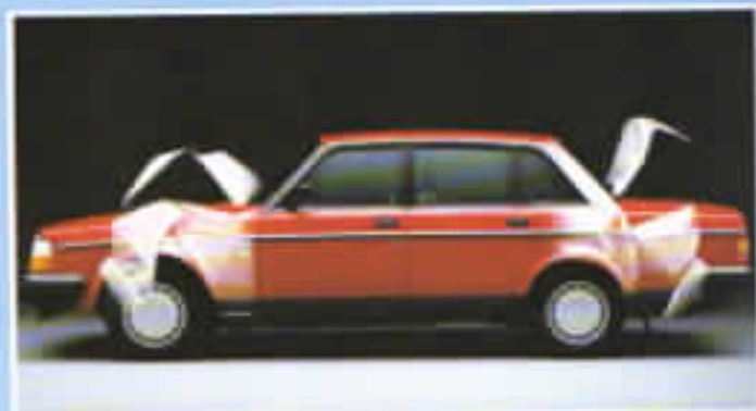
Deformationszoner fram och bak. Och tanken säkert placerad.
