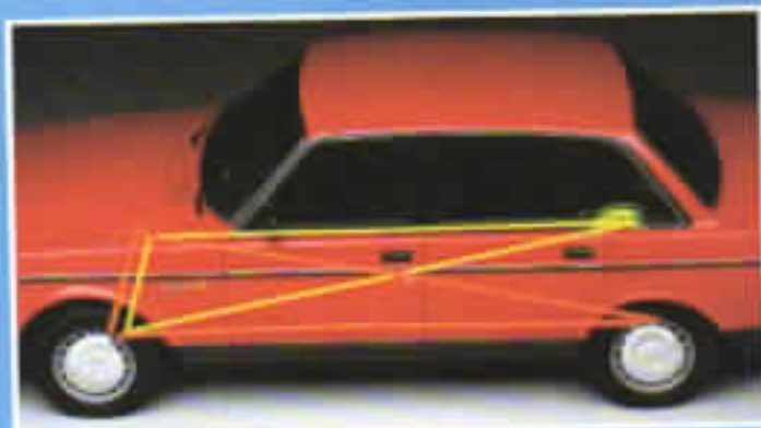
Tråkrin, triangulärt skivbromssystem. 80% av bromskraften kvarstår om ett krets skadas.
