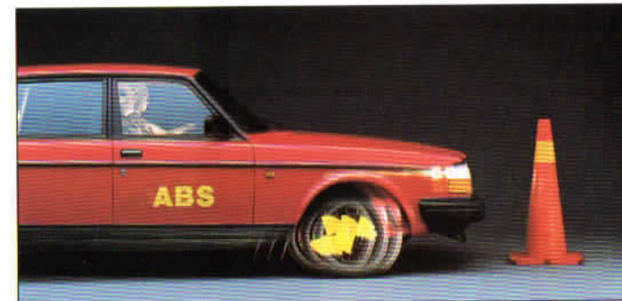
ABS – låsningsfria bromsar gör det möjligt att styra undan och bromsa samtidigt, oavsett väglaget. Standard i SE, fabriksmonterad extrautrustning till GL.
